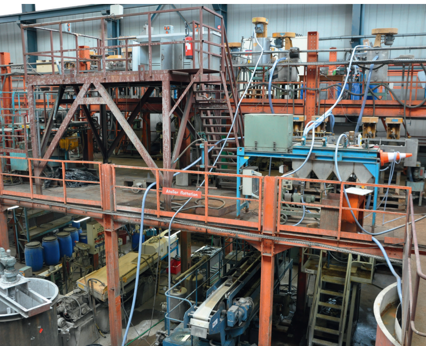
Un pilote de flottation a été élaboré avec succès dans la Halle expérimentale du BRGM, afin de recycler les terres rares contenues dans les déchets miniers. ©BRGM
